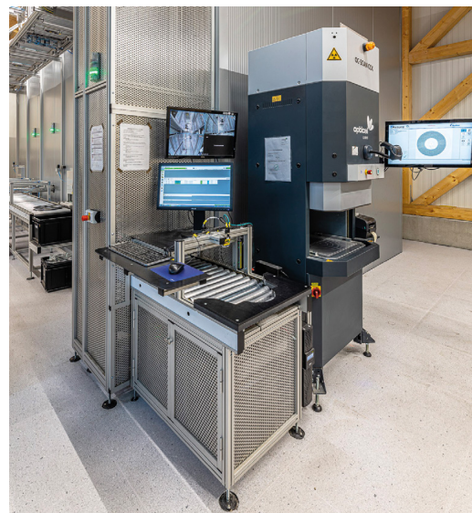
Automatisiertes Bauteilelager mit Röntgenscanner
